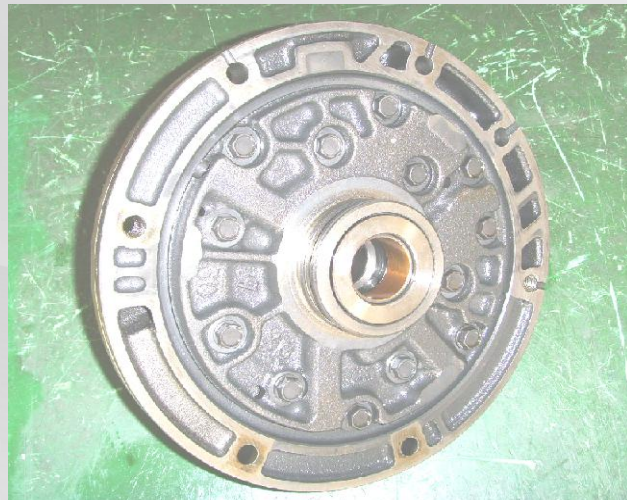
液压操纵系统(油泵)
